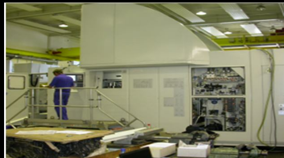
Block Machine by HELLER Germany 德国 HELLER ，机体加工中心
